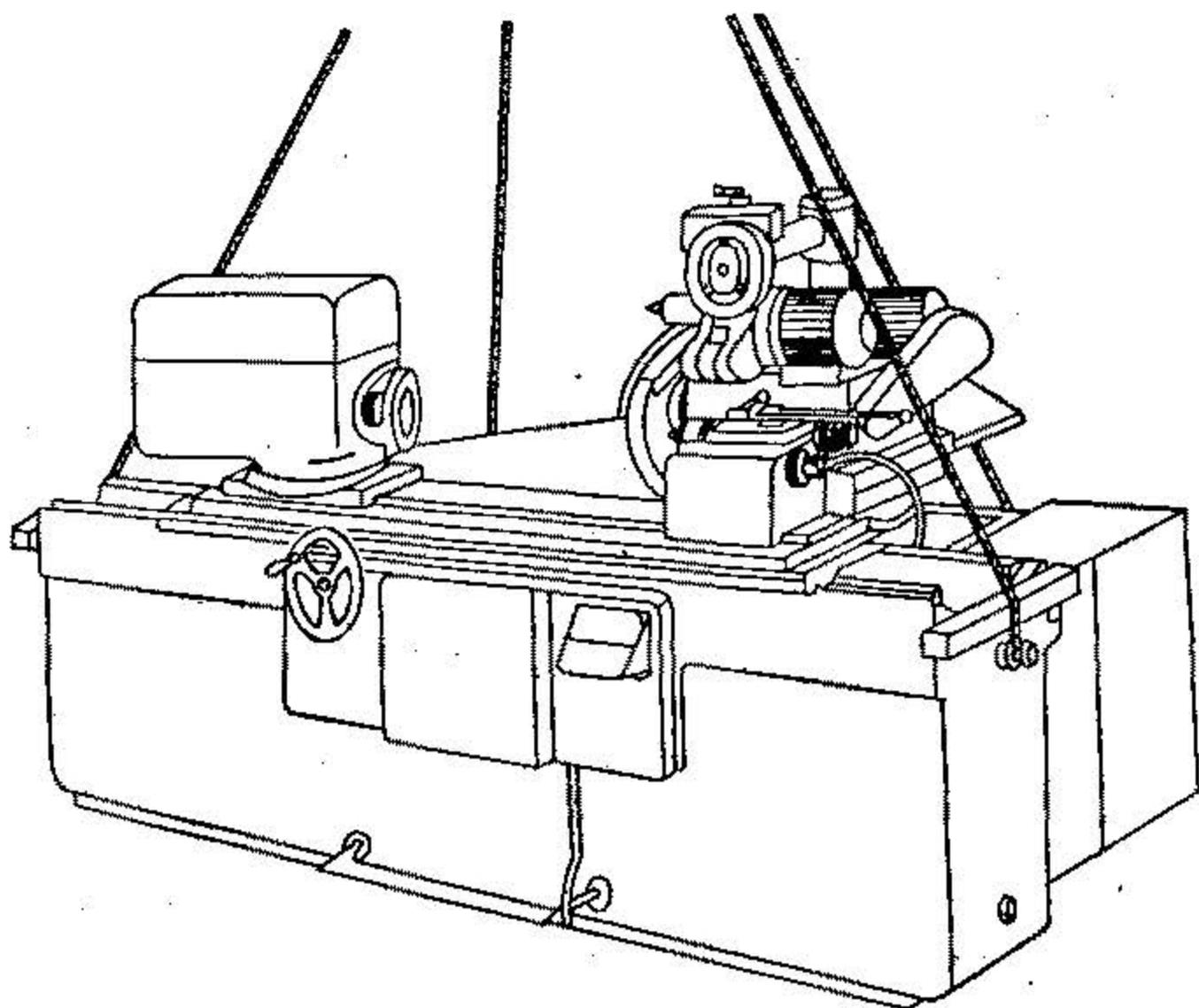
Рис. 1. Схема транспортировки станка модели 3А130
