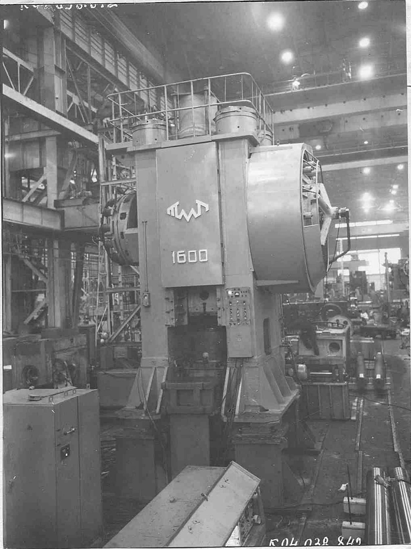
Рис. I ПРЕСС КРИВОШИПНЫЙ ГОРЯЧЕТАМПОВОЧНЫЙ СПЕЦИАЛЬНЫЙ
