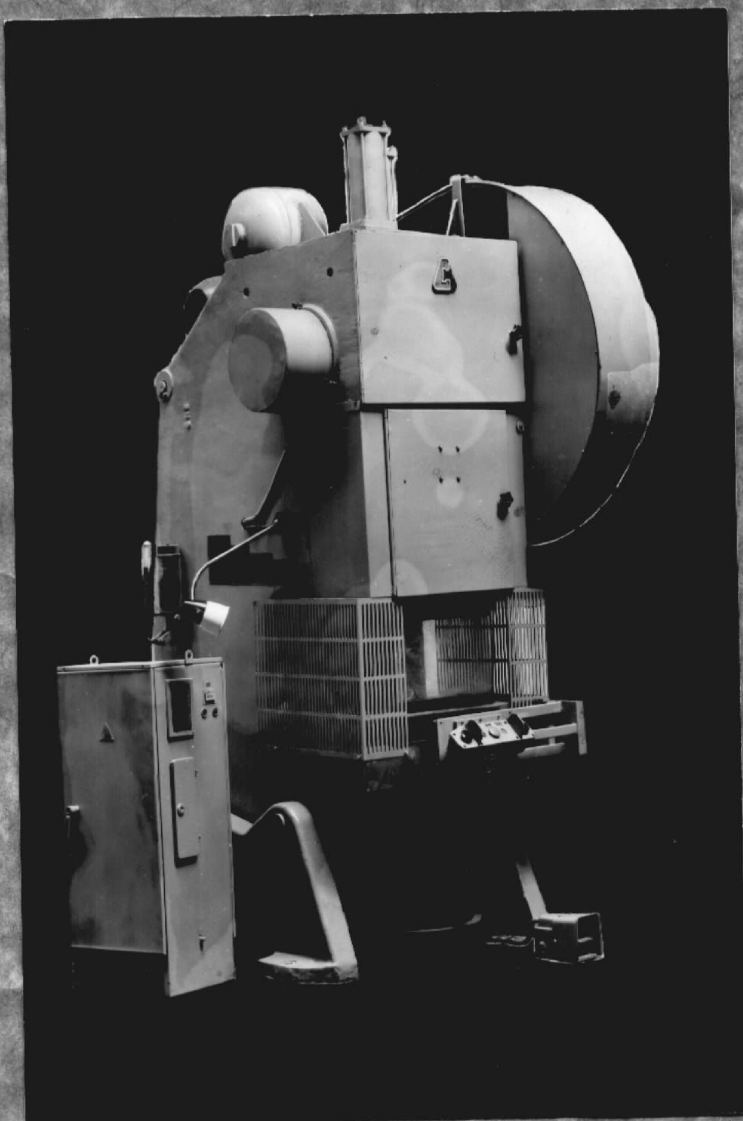
Рис. 1 Пресс однокриошпинный открытый, простого действия усилием 1000 кН
